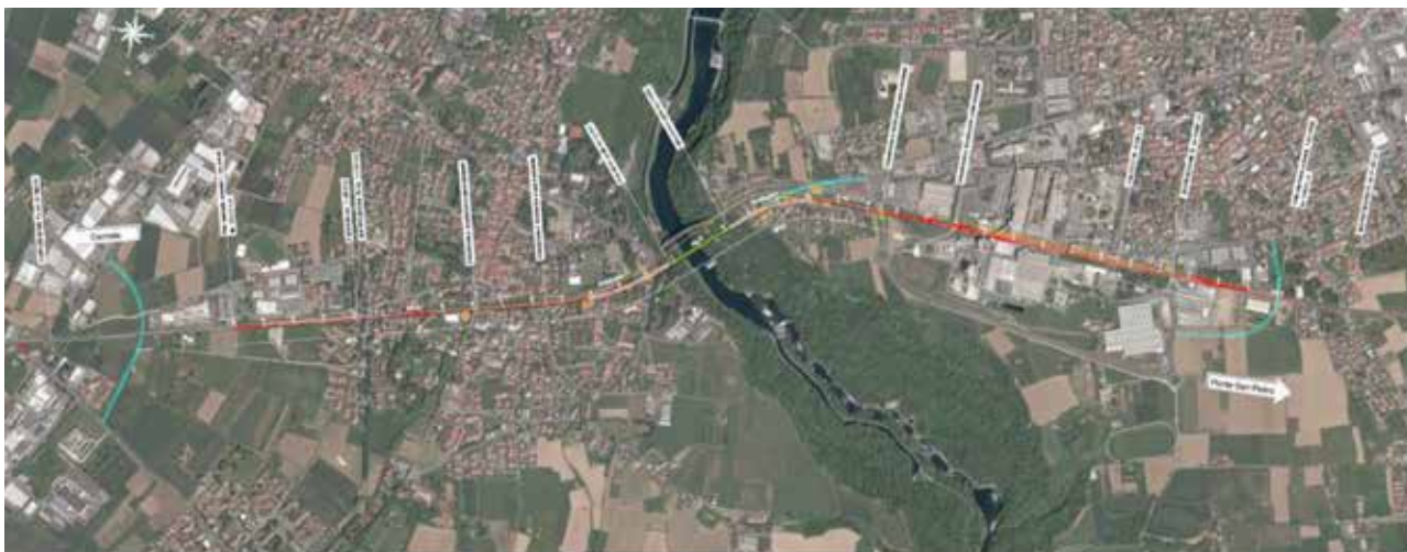
Scenario 1, che prevede: il mantenimento stazione di Paderno e Calusco, variante di modesto sviluppo 3,6 Km, mantenimento quota piano strada attuale, V= 90 km/h
